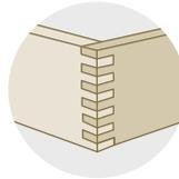
Rahmen aus massivem FSC-Holz, Schwalbenschwanz-Verbindung
